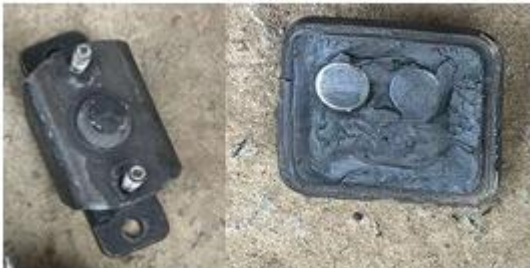
16. Base de caja de cambio, se procede a realizar el cambio del mismo
